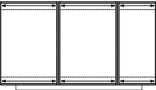
Nosta seinäkaapit seinälle asennuslistan päälle ja kiinnitä ne seinään kaappien takaosassa olevien sidelistojen läpi. Kiinnikkeet eivät sisälly toimitukseen.
