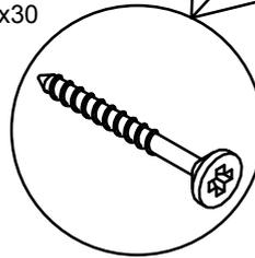
Kiinnitä kaapit lattialla toisiinsa 4x30 ruuveilla, 4 kpl / kaappipari. (Kiinnikkeet eivät sisälly toimitukseen)
