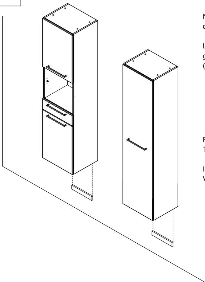
Nosta kaappi tukilistan päälle ja kiinnitä seinään kaapin takaosassa olevien sidelistojen läpi. Kiinnikkeet eivät sisälly toimitukseen.
